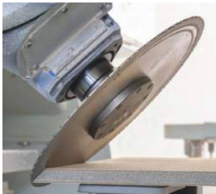
LEUCO nn-System на верстаті з ЧПК: Чистий скіс на видувному склі з фанерою з обох боків
