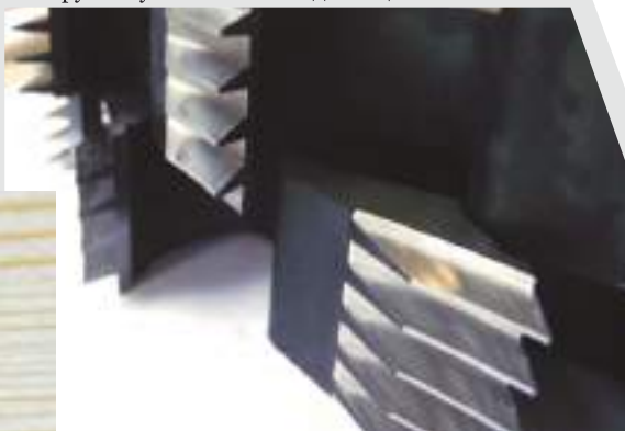
Високопродуктивна фреза для нарізки мінішипа LEUCO, яка дозволяє отримати короткі шипи та високі швидкості подачі
