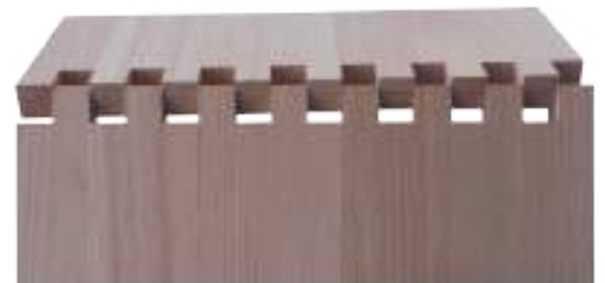
З'єднання без сколів створене кінцевою пазувальною фрезою p-System
