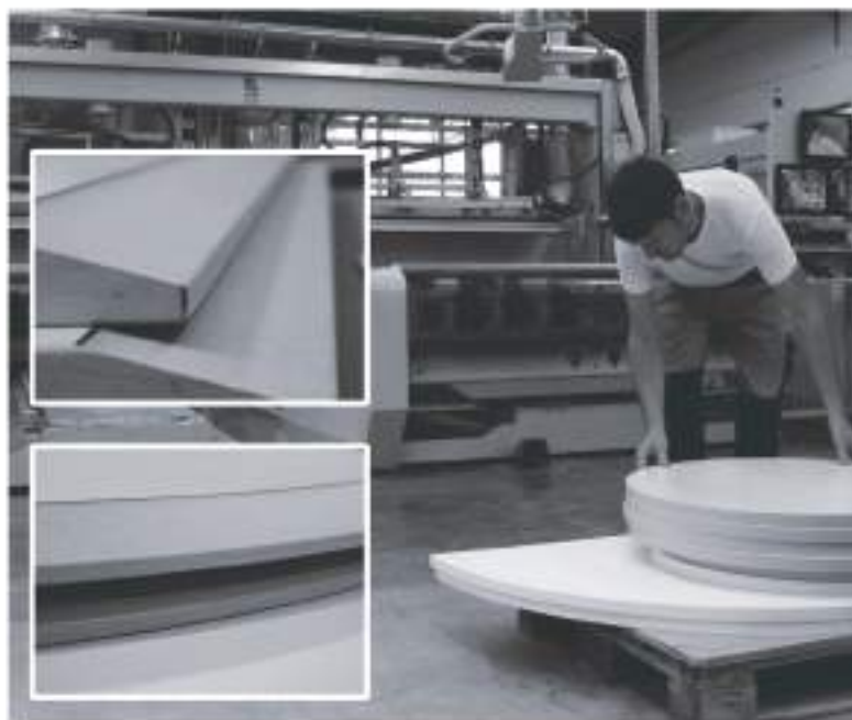
Вихід інструменту з фанерованої крайки без відколів і гладкі поверхні ведуть до комплексної обробки на верстатах з ЧПУ
