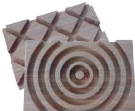
Оброблена кінцевою пазувальною фрезою p-System модрина з діагональними пазами
