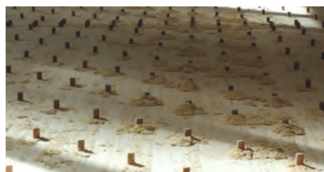
Всі збірні елементи виробляє Ромбач в Обергармербахсі (Баден-Вюртемберг) з твердої деревини з допомогою різьбових стрижнів з бука без клею. Конструкція запатентована і дозволяє отримати жорсткі компоненти абсолютно без клею.
