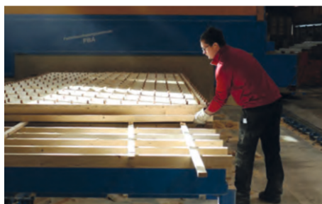
Робота на обробному центрі Hundegger була покращена Рольфом Ромбачем завдяки «LEUCO surfCut». Оскільки клієнти вимагають високої якості обробки поверхні, а фрезерування видимої сторони – елементарний крок, що потребує менше часу з новим інструментом. На зображенні Тобіас Верл.
