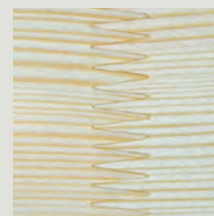
Шипорезное соединение с высотой шипов в 6 мм
